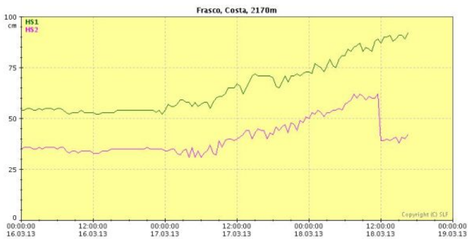
Kurven von zwei Schneehöhensensoren an der automatischen Station oberhalb von Frasco (TI). Die grüne Kurve veranschaulicht den Schneehöhenanstieg mit dem Schneefall auf einem flachen Messfeld. Die lila farbene Kurve misst die Schneehöhe im Hang. Der rasche Abfall der Kurve am Mittag des 18.03. ist sehr wahrscheinlich auf einen Lawinenabgang unterhalb des Sensors zurückzuführen.
