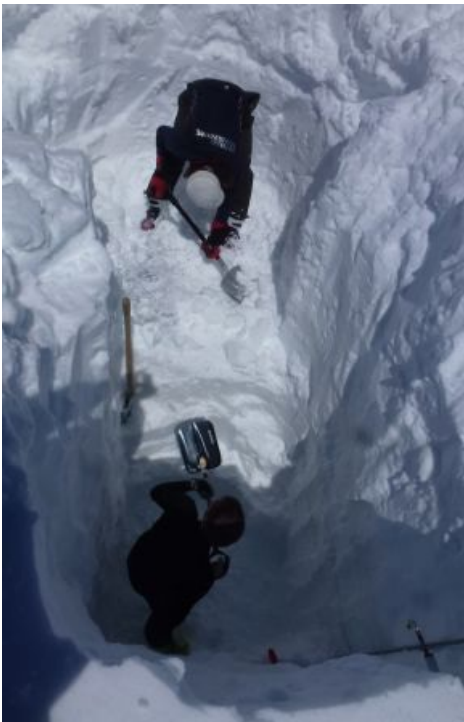
Der Gesamtwasserwert der Schneedecke dient als Grundlage für die Berechnung der Massenbilanz eines Gletschers. Für dessen Messung musste dieses Frühjahr auf dem Claridengletscher (GL) zunächst ein 4.5 m tiefer Schacht ausgehoben werden (G. Kappenberger, 18.05.2014).
