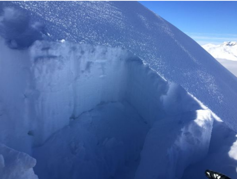
Beim 2. Schlag aus dem Ellbogen brach dieser Stabilitätstest am Nordhang vom Nüllisch Grat (Davos, GR) auf rund 2480 m am Übergang zum schwachen Altschnee (Foto: J. Appel, 24.01.2015).
